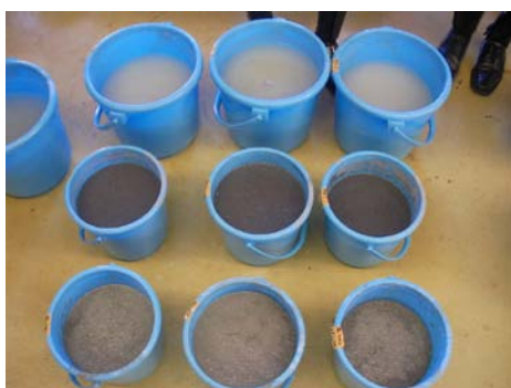
図表 3-5 試料の投入～離解～フローテーション～採取
