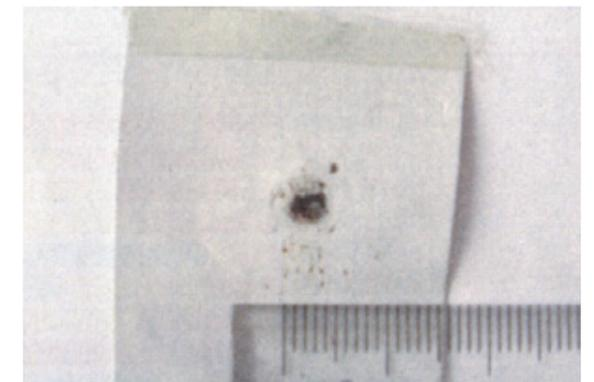
□ 感熱性発泡インクが抄き込まれ、ドライヤーパートで二次発泡し、板紙の表面が膨らんだもの（白板紙）
