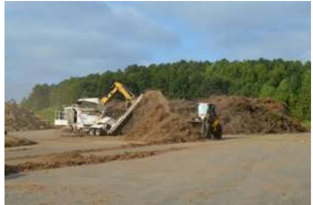
図6-13 庭木くずの破砕機（Foxhole facility）
