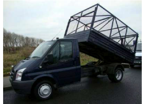
図 5.2 フォード社のケージ付収集車 出典: Vanlocator.Co.UK
